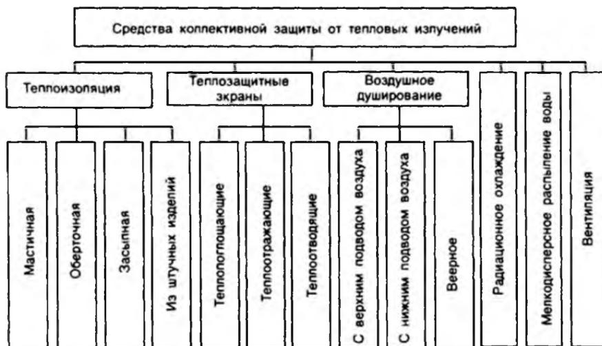
Рис. 6.1. Классификация средств промышленной теплозащиты
