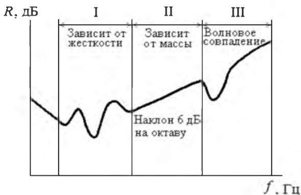
Рис. 11.3. Частотные диапазоны звукоизоляции однослойного ограждения
