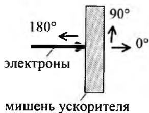
Рис. 9.11. К направлению выхода тормозного излучения из мишени
